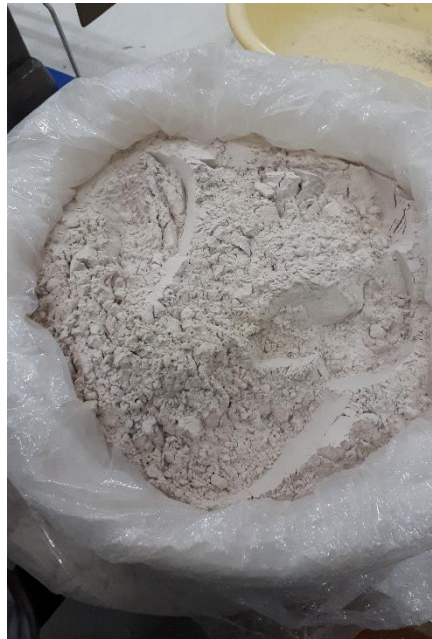
Gambar L-1.4 Serbuk Kaca yang Telah Dihancurkan, Disaring dan Dioven
