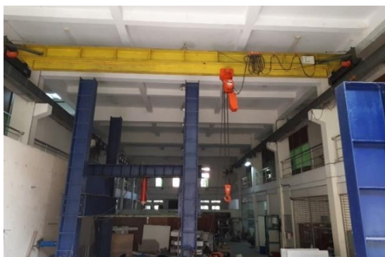
Gambar 4.6 Crane dan Loading Frame
