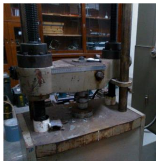
Gambar 4.11 Uji Tekan Mortar
