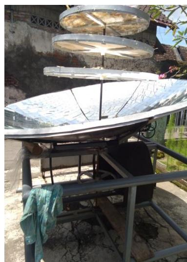
**Gambar 3. Alat Pengering Tipe Parabola**
