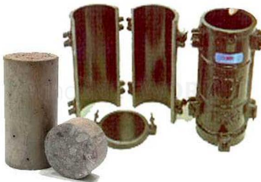
Gambar 4.2 Cetakan Silinder Beton
