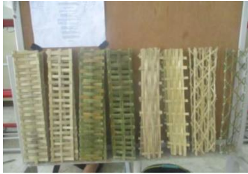
Gambar 4. Contoh Anyaman Silang Bambu untuk Tulang Beton
