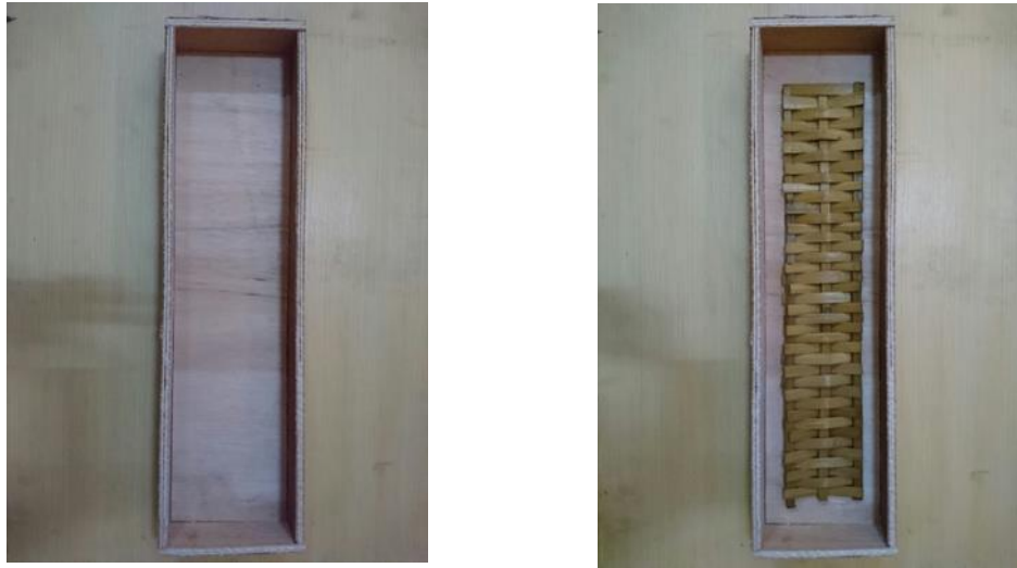
Gambar 4. Persiapan Cetakan Beton
