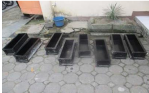
Gambar 5. Cetakan Plat Beton Bertulang Bambu
