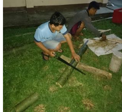
Gambar 1. Cara Pemilihan dan Pemetongan Bambu
