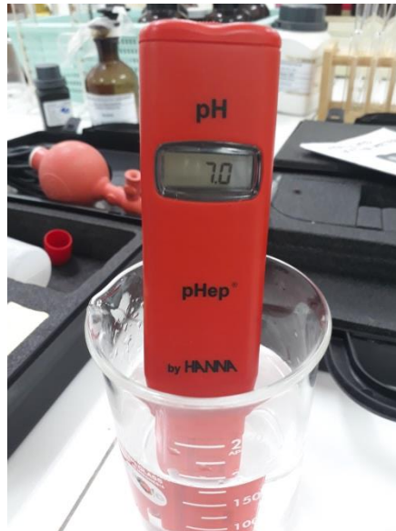
Gambar 4.1 Pengukuran pH menggunakan pH meter
