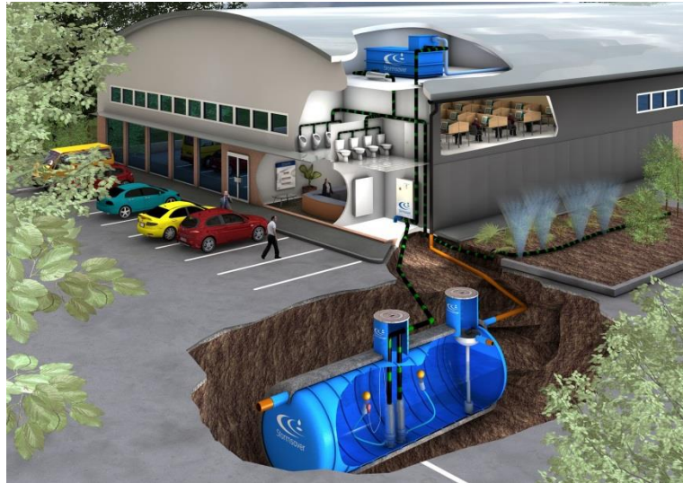
Gambar 3.1. Sistem PAH untuk Bangunan Komersil dan Industri.
