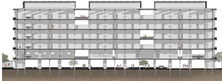
Gambar 3.46 Potongan efek sidelighting kaca louvre
