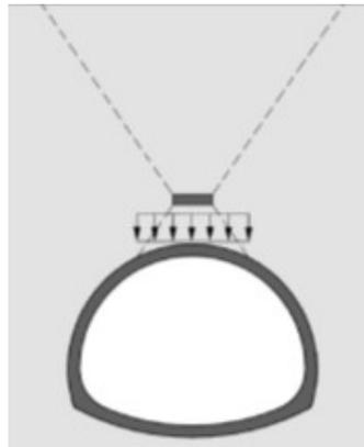
**Gambar 3.5 Pembebanan pada lapisan terowongan pada *compensation grouting***
