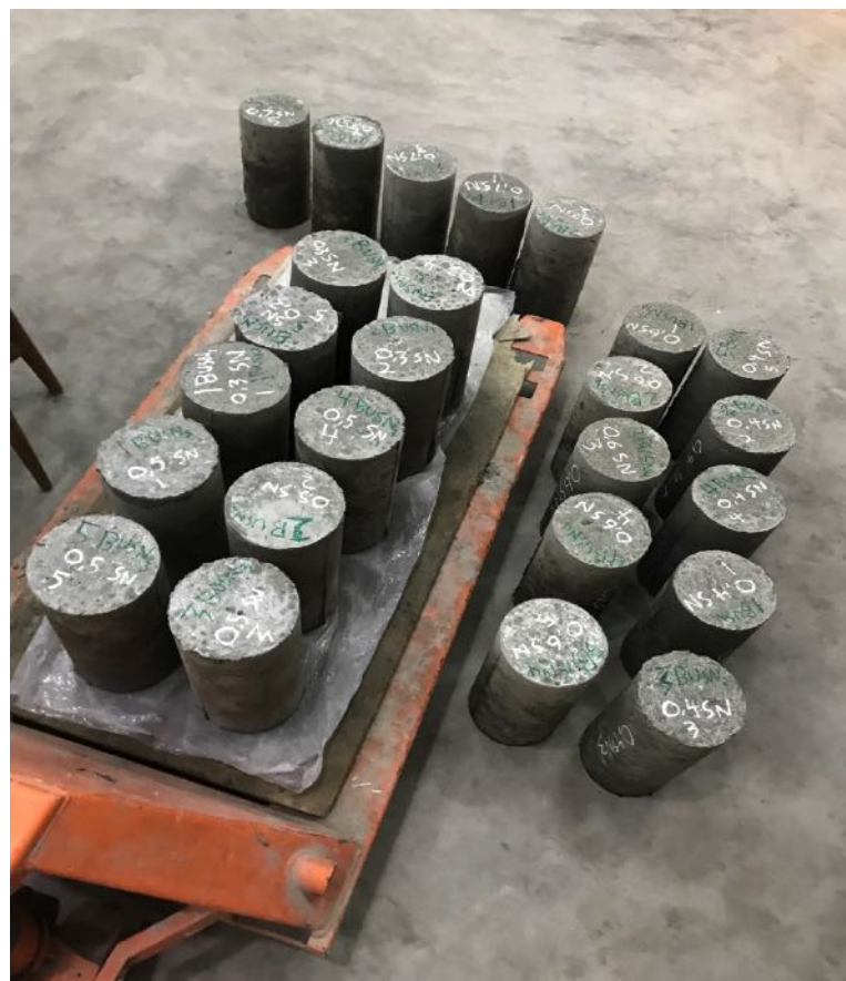
Gambar L 3-4.8 Pelepasan Benda Uji Dari Cetakkan Silinder
