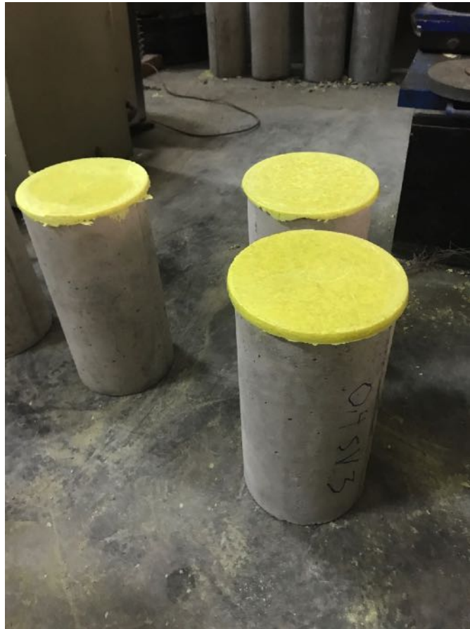
Gambar L 3-5.5 Benda Uji Setelah Di Capping
