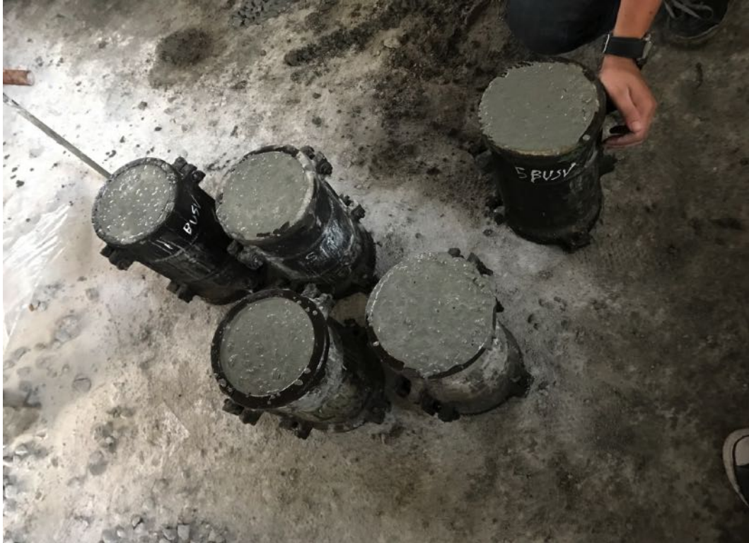
Gambar L 3-4.7 Benda Uji Dalam Cetakkan Silinder
