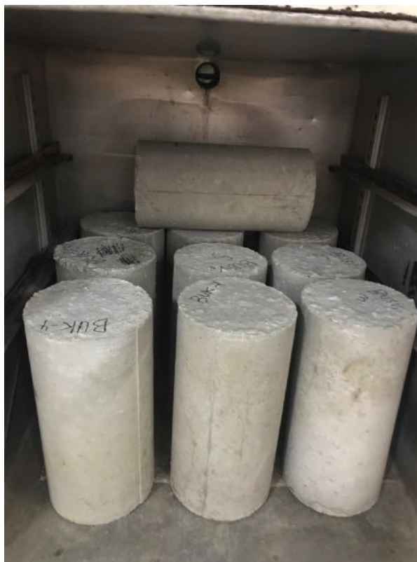
Gambar L 3-5.2 Benda Uji Kering Oven (Uji Daya Serap Air)
