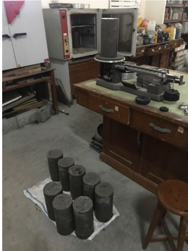
Gambar L 3-5.1 Penimbangan Berat Benda Uji SSD (Uji Daya Serap Air)
