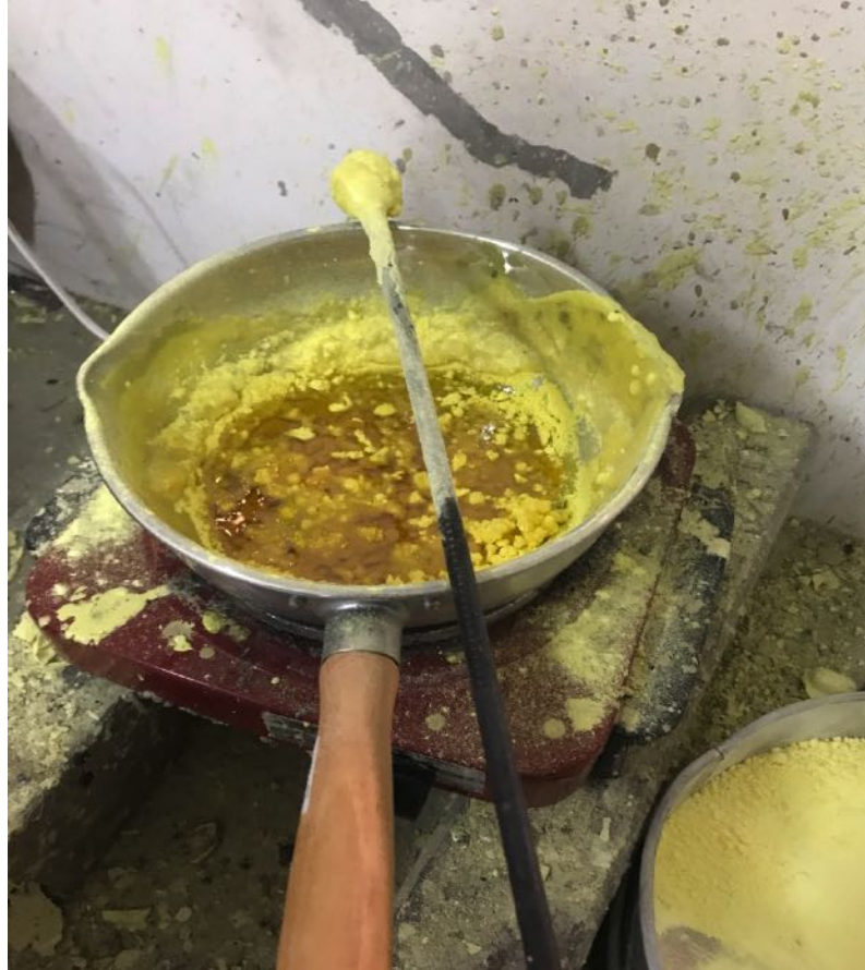
Gambar L 3-5.3 Pemanasan Mortar Belerang
