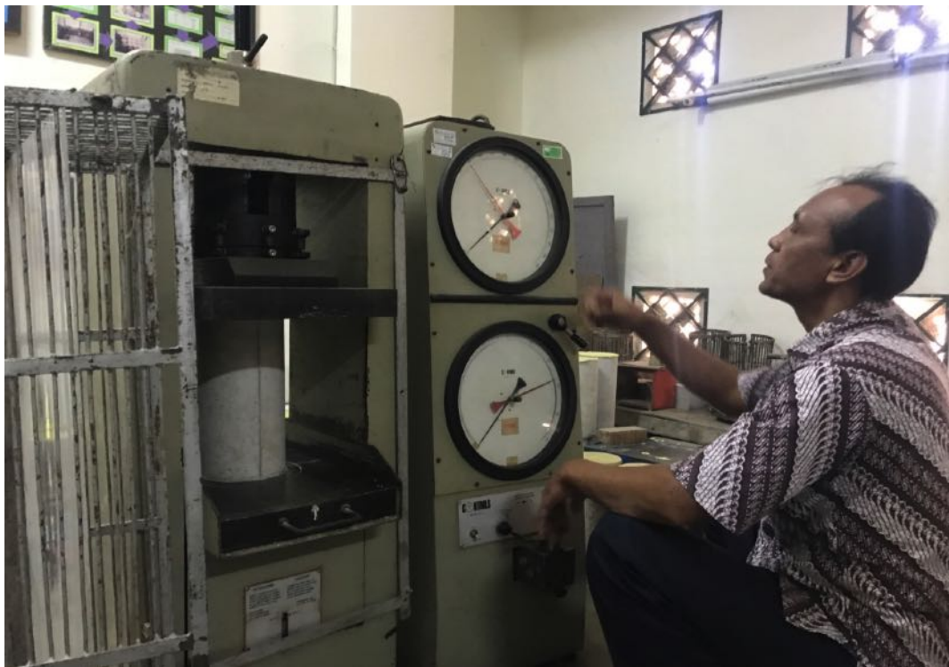
Gambar L 3-5.6 Pengujian Kuat Tekan Beton
