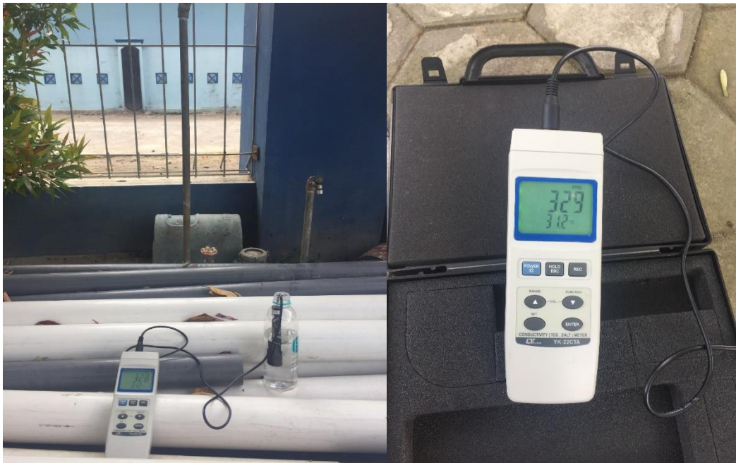
Pembacaan Sampel untuk uji TDS dengan TDS Meter
