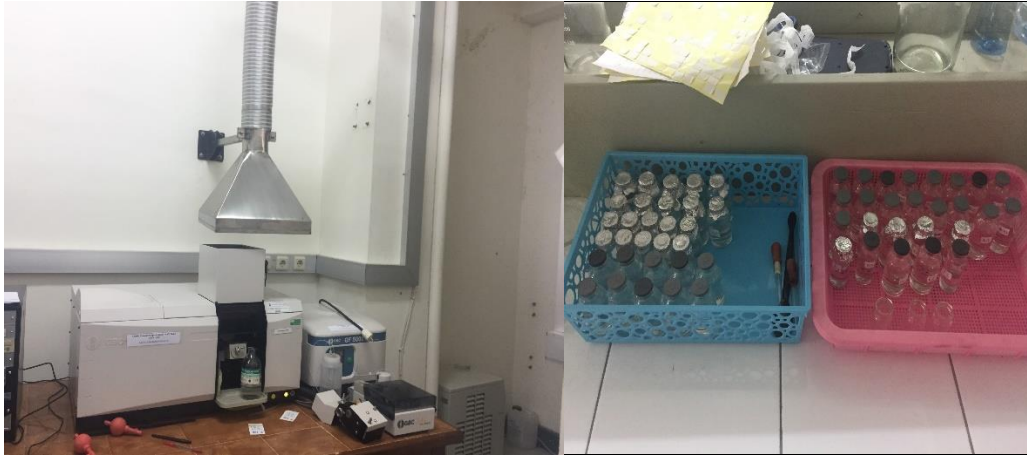
Pengujian sampel untuk uji besi dengan alat AAS
