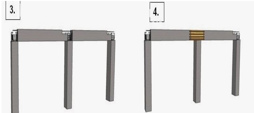
Gambar 3.5 Contoh sambungan/ joint pada kolom dan balok
