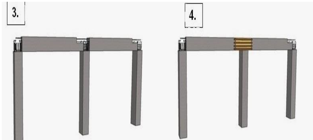
Gambar 3.5 Contoh sambungan/ joint pada kolom dan balok
