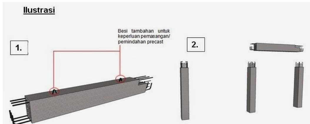
Gambar 3.4 Pengangkatan balok pracetak
