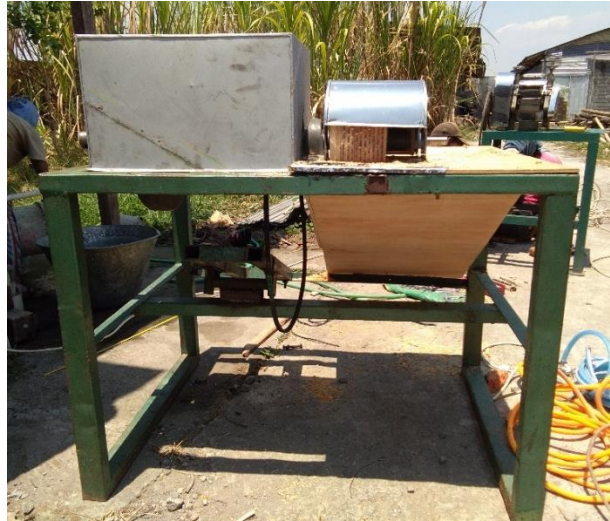
Gambar 4.7 Tampak Belakang Mesin Usulan Pamarut Sagu
