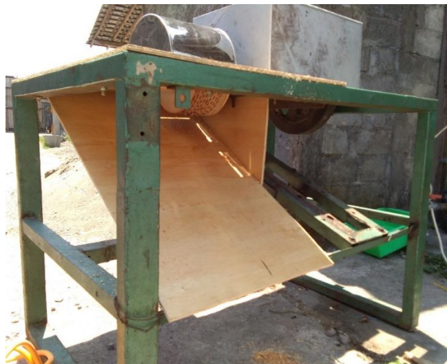
Gambar 4.8 Tampak Depan Mesin Pamarut Sagu Usulan
