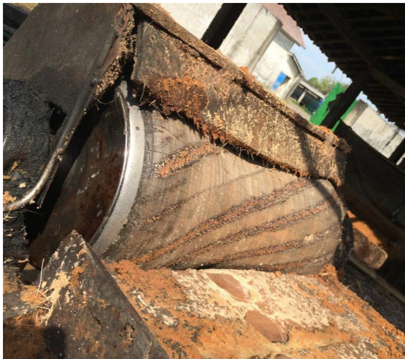
Gambar 4.2 Bagian detail jarum baja dan pengaman yang dipasang pada mesin pamarut sagu
