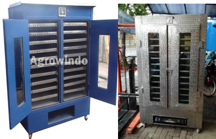
Gambar 2.1.2 Alat Pengering ( Tray Dryer ) 2 Pintu
