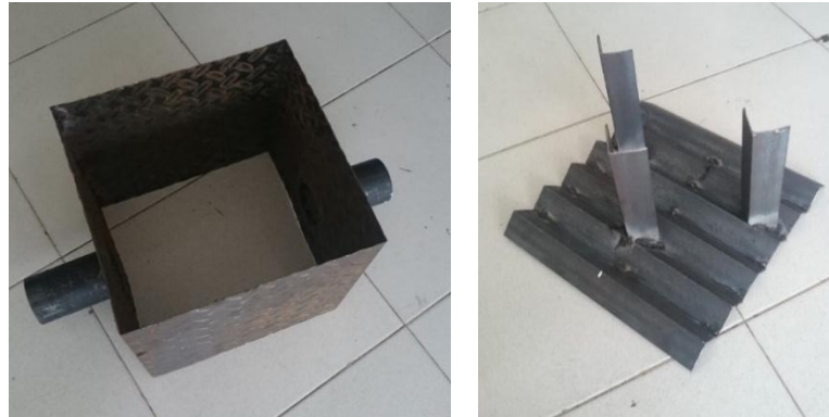
Gambar 4.3.4 Dinding Pemanas (kiri) dan Bagian Dalam Pemanas (kanan)
