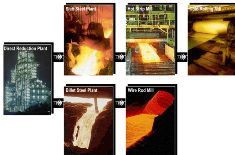
Gambar 4.1 Skema proses produksi PT. Krakatau Steel (Persero) Tbk.
