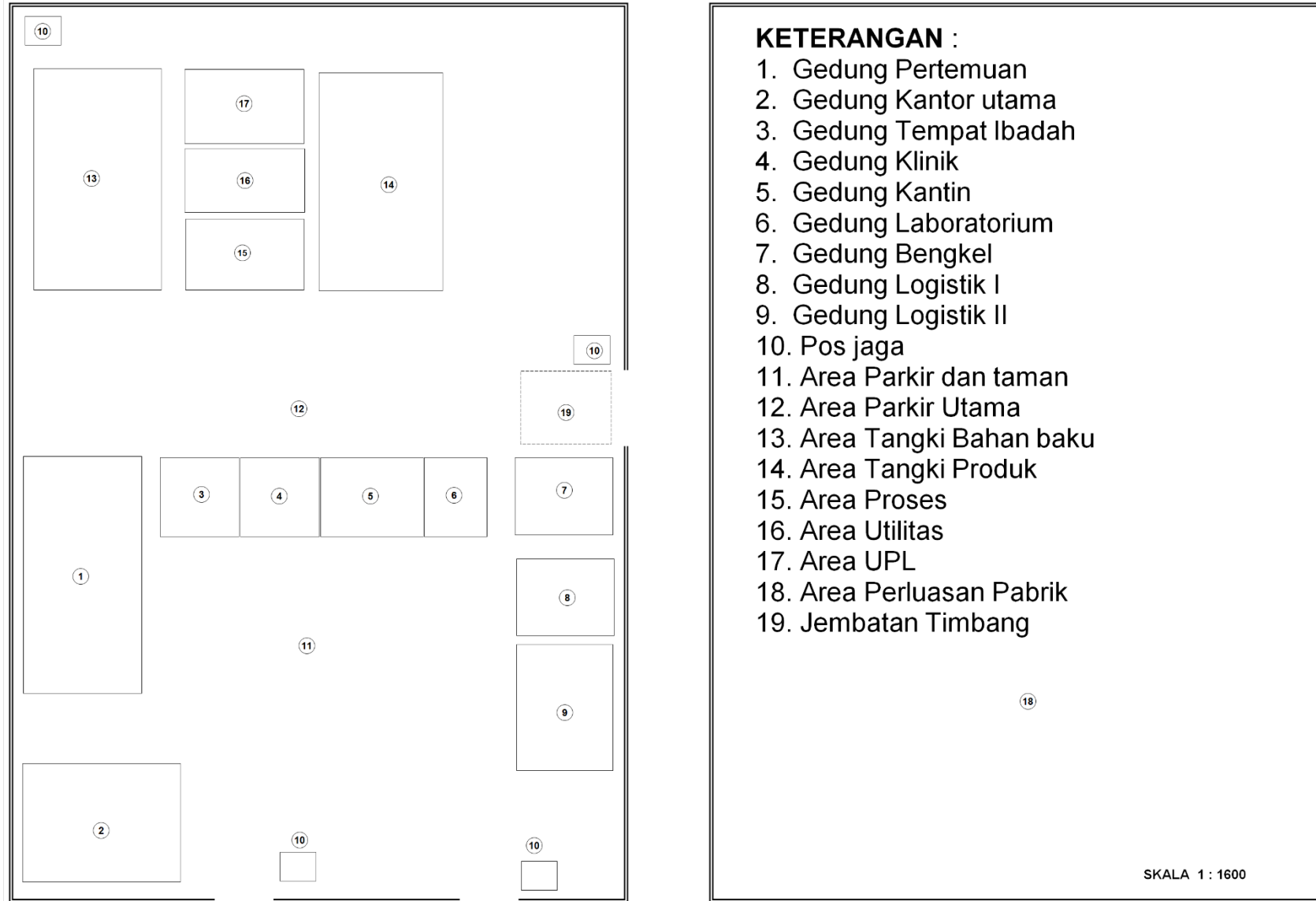
Gambar 4. 2 Tata Letak Pabrik Skala 1 : 1600
