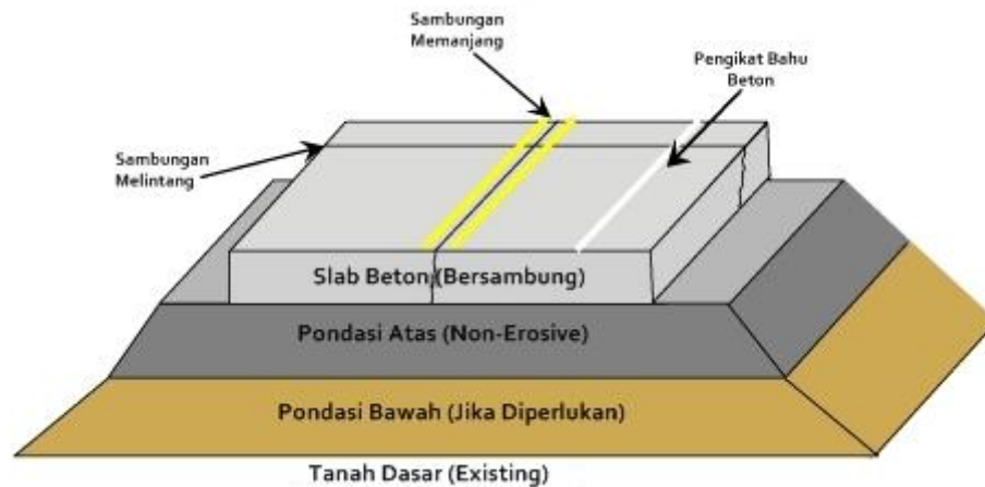
Gambar 3.1 Susunan Lapisan Perkerasan Kaku ( Rigid Pavement )
