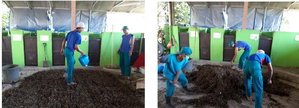
Gambar 4. 15 Proses Penyiraman dan Pengadukan
