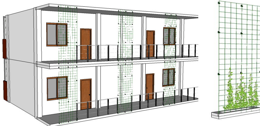
Gambar 3. 17 Penerapan green facade pada area koridor
