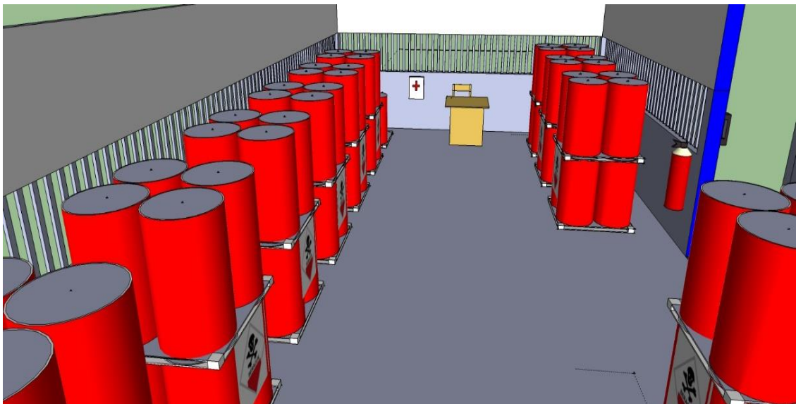
Gambar 6: Desain susunan meja, kotak K3, dan APAR di dalam TPS
