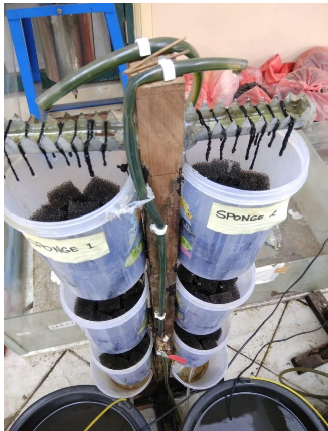
Gambar 4.7 Keadaan Reaktor I dan II setelah dilakukan Sistem Resirkulasi
