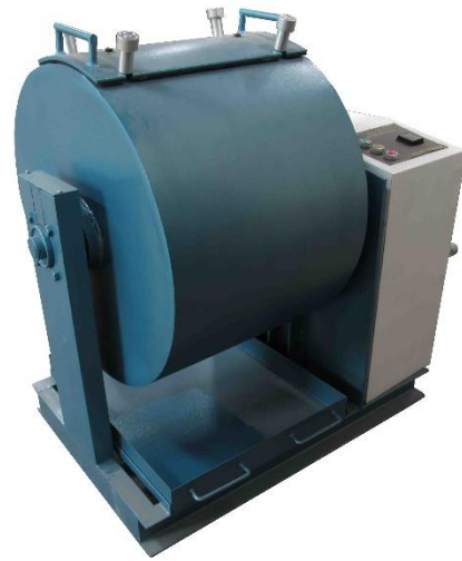
Mesin Loss Angeles
