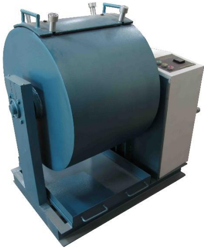
Mesin Loss Angeles
