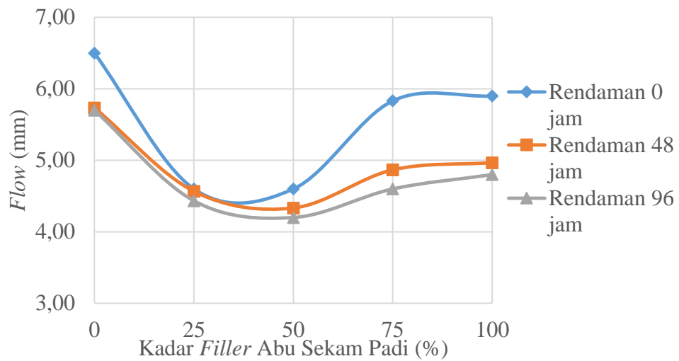
Gambar 5.12 Pengaruh Kadar Filler ASP Terhadap Flow Campuran SMA 0/11 Pada Berbagai Variasi Durasi Rendaman Air Laut
