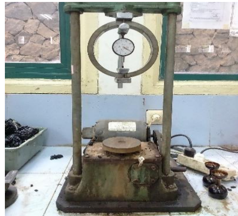
Alat Pengujian Marshall dan Immersion
