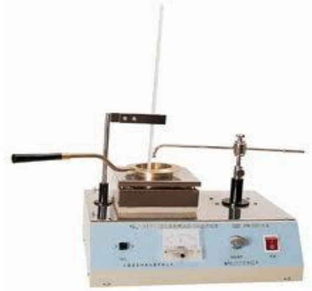
Alat pengujian titik nyala dan titik bakar aspal
