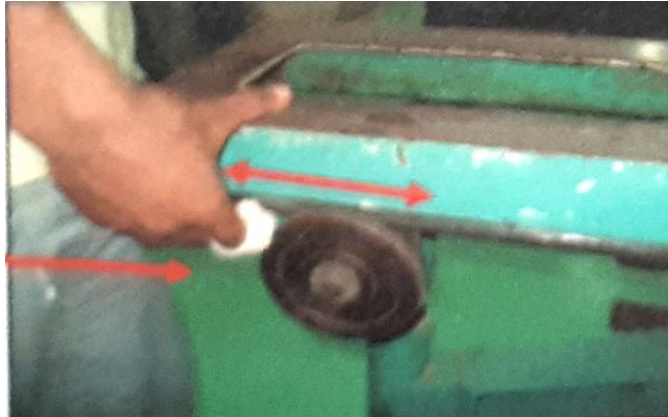
Gambar 5. 8 Contoh Potensi Bahaya Tangan Terjepit Rel Roller
