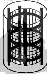
Gambar 4.6 Beton bertulang dengan sengkang dan jaringan kawat
