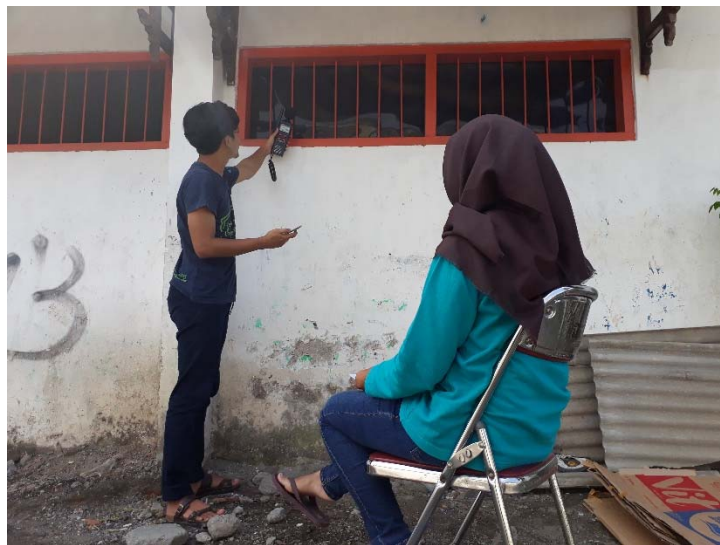
Gambar (6) Pengambilan data di luar ruang perpustakaan menggunakan alat Sound Level Meter
