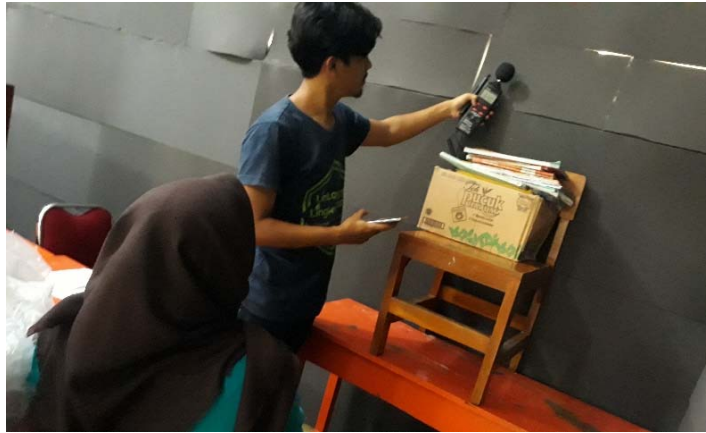
Gambar (5) Pengambilan data di dalam ruang perpustakaan menggunakan alat Sound Level Meter
