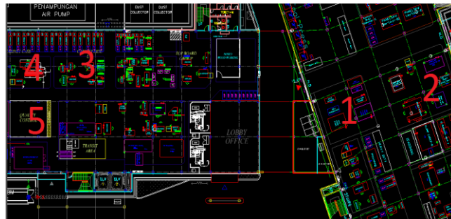
Gambar 4.4 Alur Stasiun Kerja Pembuatan Kabinet Top Frame Center
