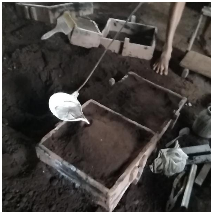
Gambar 4. 7 Penuangan Alumunium Cair
