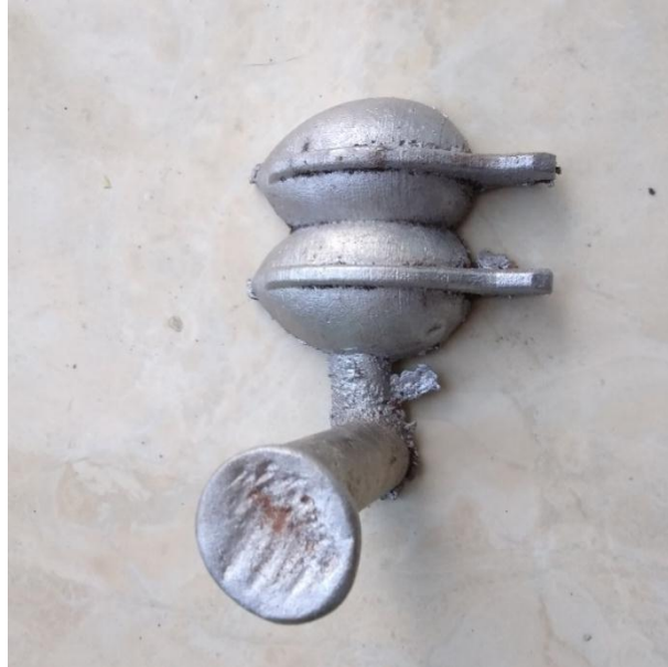
Gambar 4. 8 Hasil Pengecoran Alumunium
