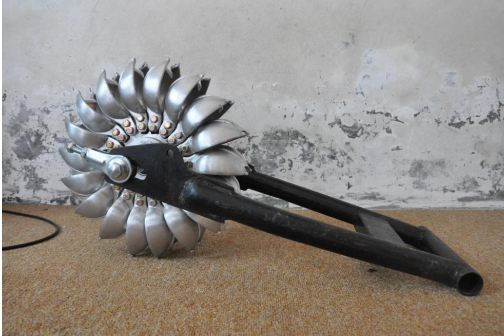
Gambar 4. 13 Pemasangan Poros Turbin
