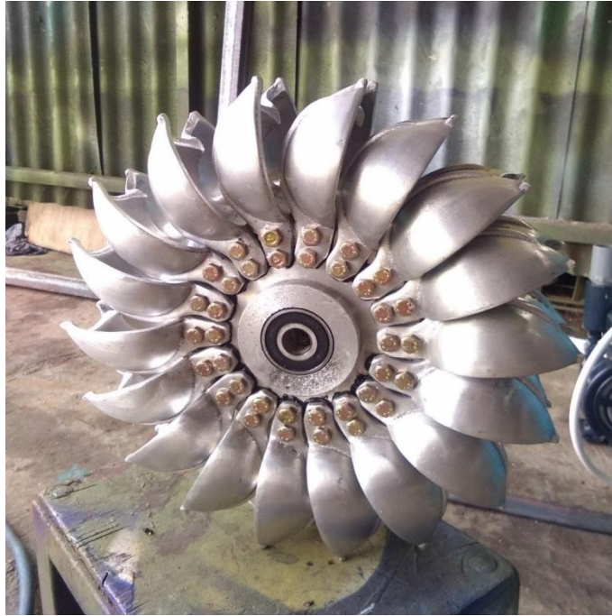
Gambar 4. 10 Komponen Utama Turbin Pelton
