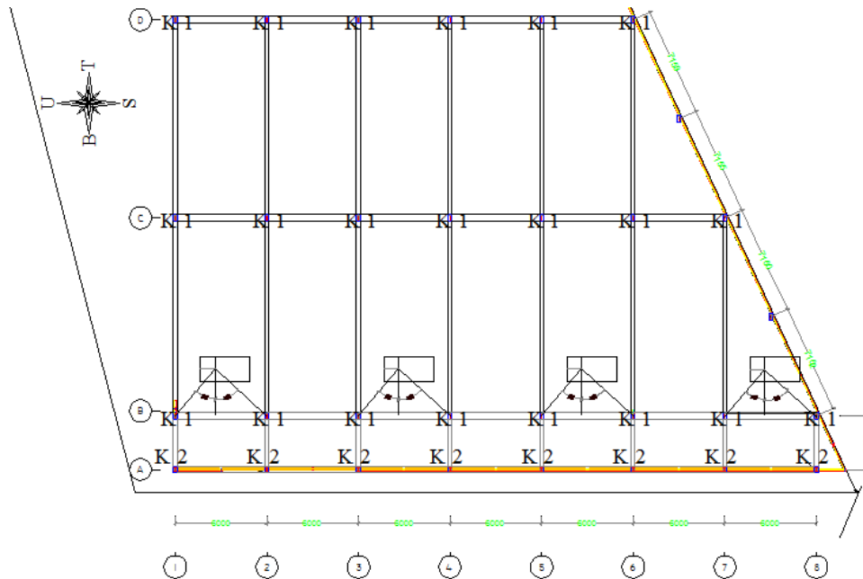
Gambar 5. 10 Posisi Truck Crane Terhadap Kolom
