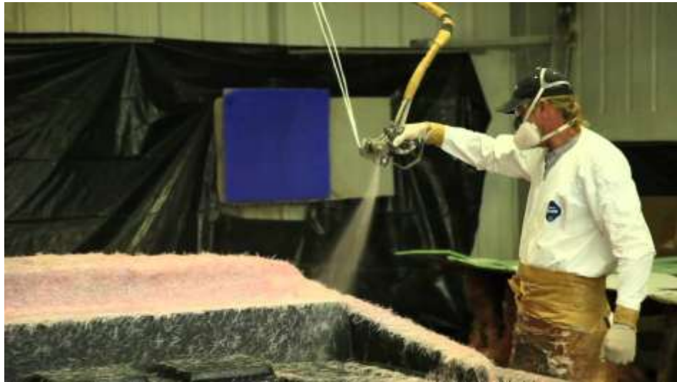
Gambar 3. 4 Ilustrasi pembuatan komposit dengan metode spray up
