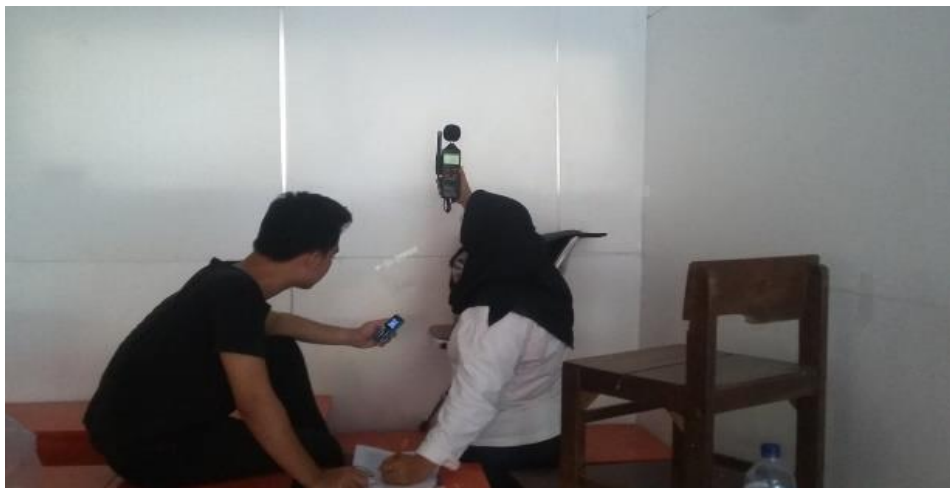
Gambar 10. Proses pengambilan data kebisingan di dalam ruangan
