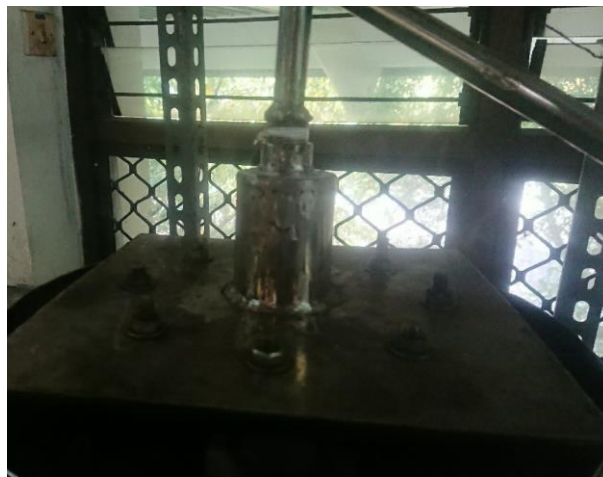
Gambar 3.9 Asap Keluar Dari Tutup Kolom Pada Proses Pirolisis
