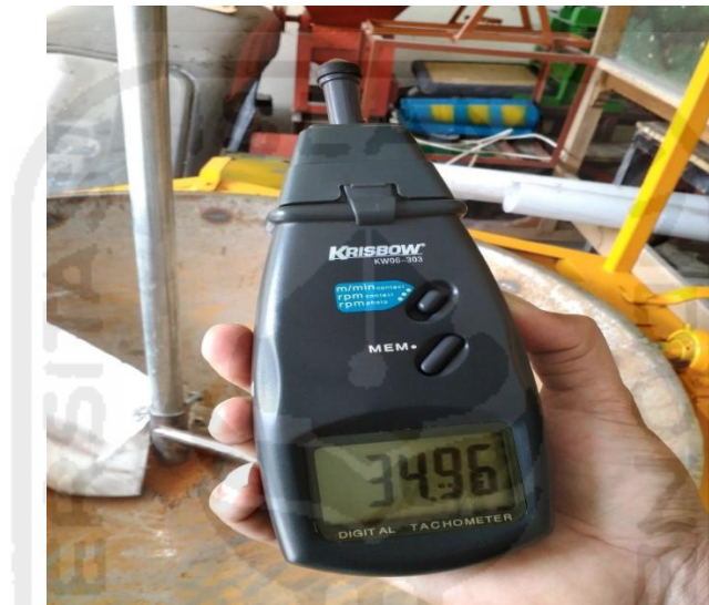
Gambar 4.6 Hasil pengukuran menggunakan tachometer
