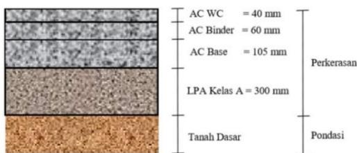
**Gambar 7. Potongan Melintang Lapis Perkerasan Lentur Jalan**
