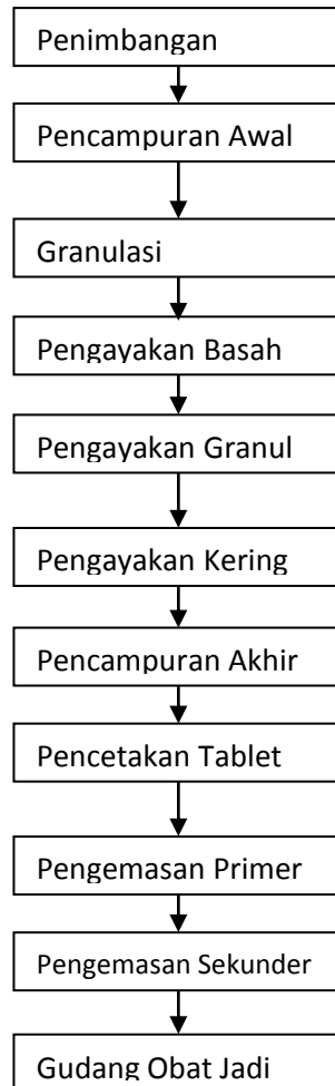
Gambar 4. 2 Alur Produksi Sediaan Padat
