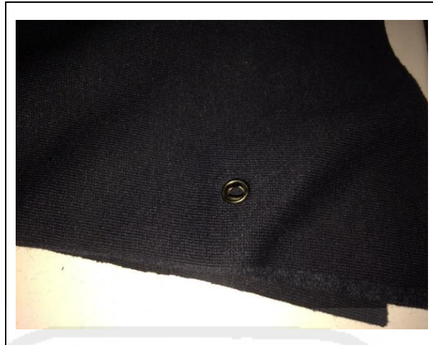
Gambar 4.17 Hasil proses pelubangan mata ayam
