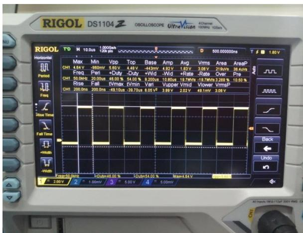
Gambar 4.2 Sinyal keluaran PWM dari arduino uno
