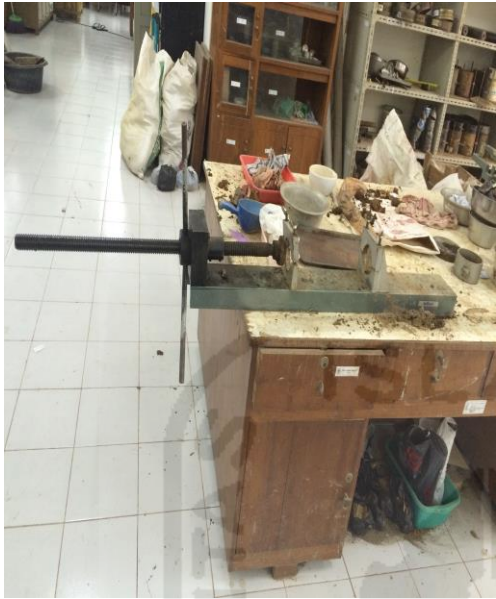
Kondisi Peletakan Alat Sample Extruder Horizontal Yang Berpotensi Bahaya
