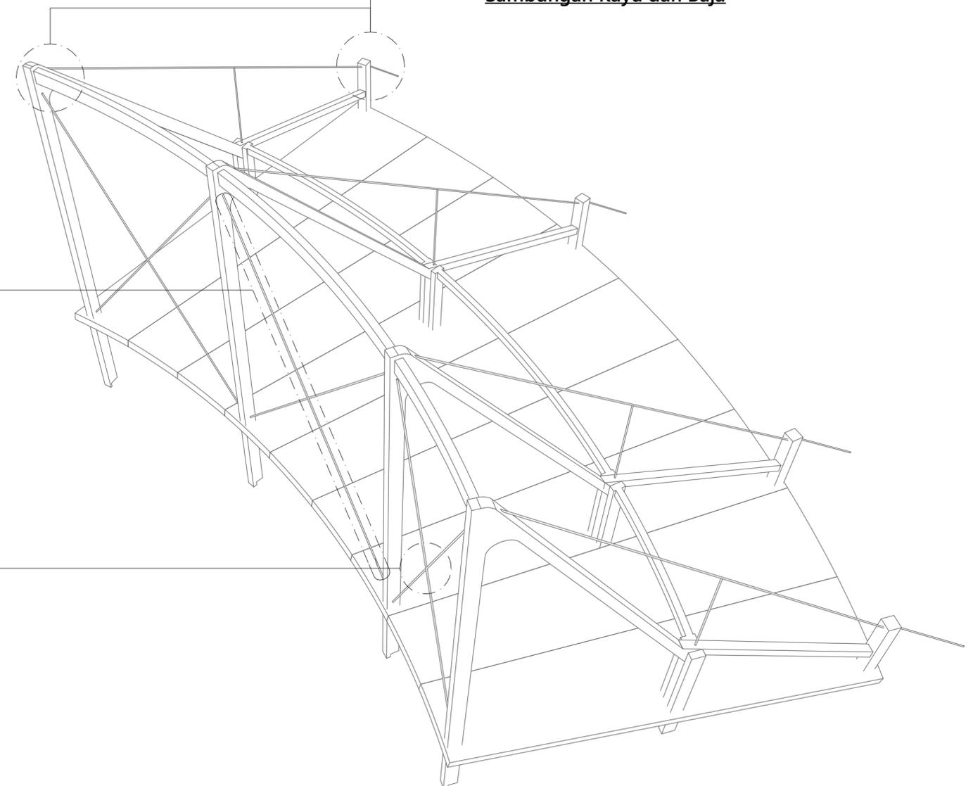
**DETAIL RANGKA KAYU DAN KABEL BAJA**
