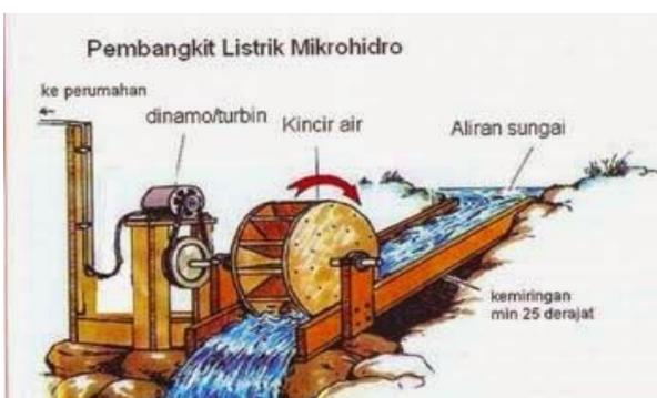
Gambar 16. Pembangkit Listrik Mikrohidro (*Tenaga Air*).
