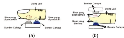
Gambar 4. (a) Metode Transmisi (b) Metode Refleksi [8]
