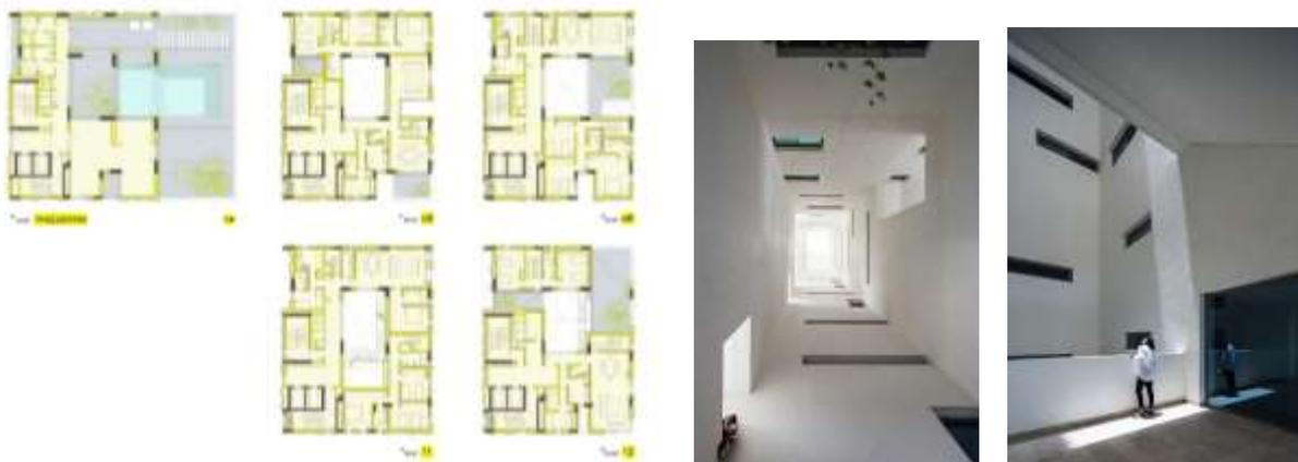
mengurangi konsumsi energi. Bukaan minimum ditempatkan pada fasad yang menerima paparan sinar matahari yang paling banyak. Pada bagian sisi utara bangunan terbuka menghadap ke pemandangan laut. Bangunan ini mengoptimalkan pencahayaan alami dan *Cross ventilation* yang mempengaruhi bentuk orientasi bangunan ini.
