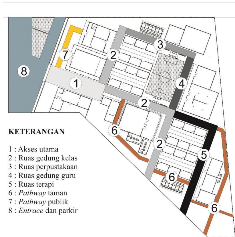
Gambar 3. 28 Skematik ploting pola perkerasan sirkulasi sesuai dengan fungsi gedung
