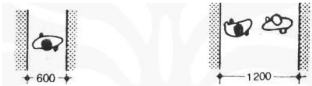
Gambar 2.33 Lebar sirkulasi horizontal (Neufert, 2002)
