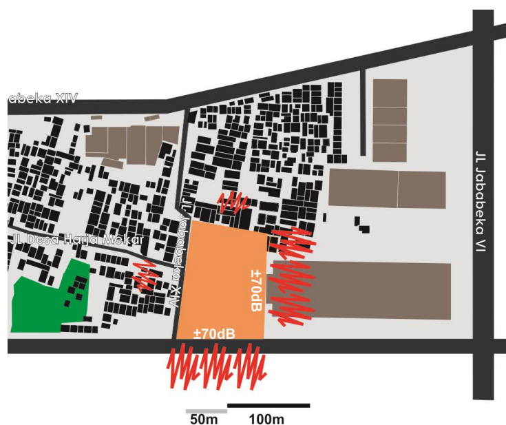
Gambar 3.2 Kondisi eksisting kebisingan.
