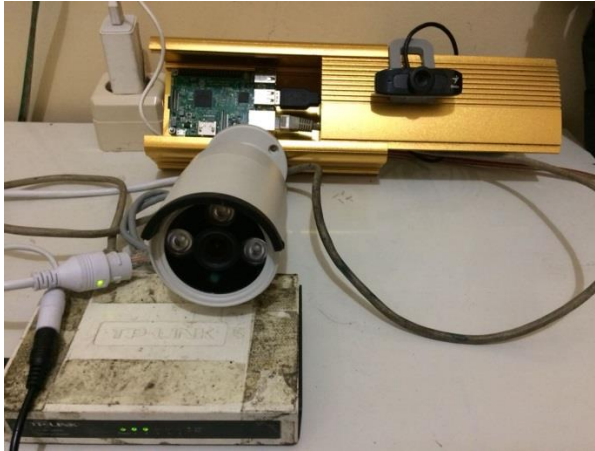
Gambar 4.2 Rangkaian komunikasi kamera usb dan ip kamera
