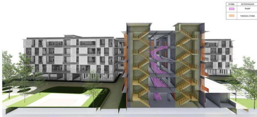
**Gambar 5.29 Skema Transportasi Vertikal**
