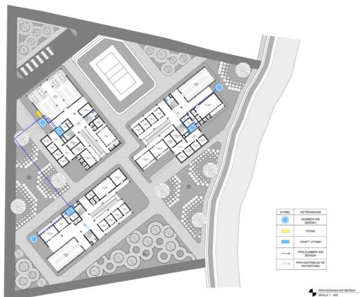
Sistem distribusi air bersih pada bangunan rumah susun cokrokusuman menggunakan system down feed dengan sumber air utama yang berasal dari PDAM dengan cadangan dari sumur air bersih. Penggunaan sistem ini agar lebih efisien untuk digunakan dalam bangunan berlantai banyak. Sedangkan untuk limbah dari bangunan dibuang ke roil kota. Pada setiap blok hunian memiliki satu area pembuangan dan resapan.
