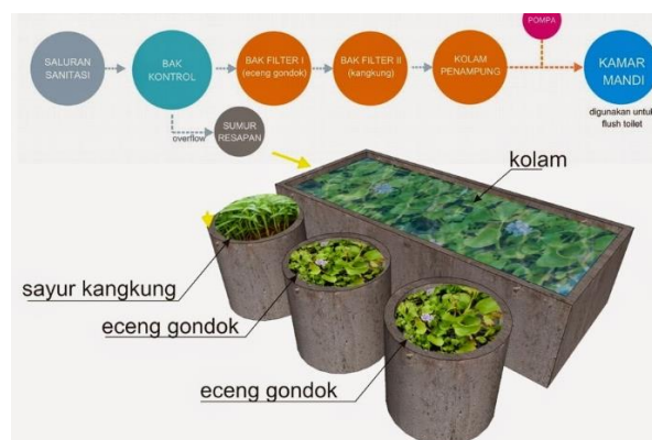
Gambar 2.36 Ilustrasi Proses Filtrasi Air Limbah dengan Bak Filter Organik
