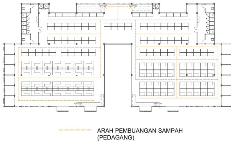
Gambar 3. 68 Skematik Sistem Pembuangan Sampah Lantai 2
