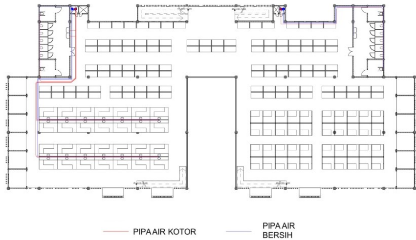
Gambar 3. 65 Skematik Sistem Air Bersih dan Air Kotor Lantai 2
